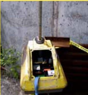
Une jauge portable contenant une source d'américium 241/ béryllium et une source de césium 137
